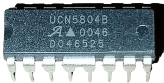
Controlador UCN5804B para motores paso a paso unipolar
